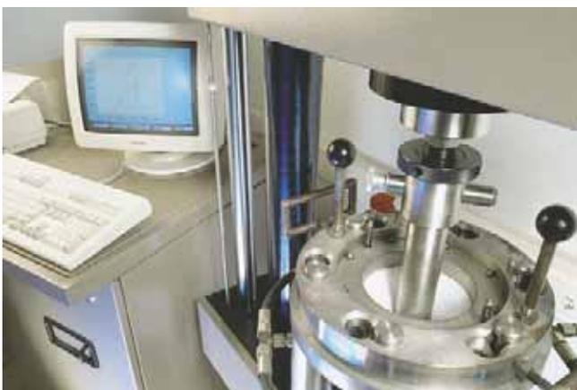
1 Stempeldurchdrückversuch – hierbei wird das Durchdrücken eines Steines durch ein Geotextil simuliert und dient zur Klassifizierung der Robustheitsklasse auch von Vliesstoffen
